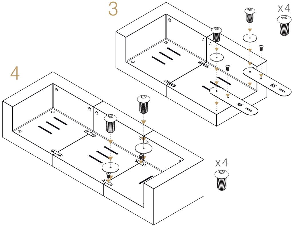
EJEMPLO DE MONTAJE 02 / ASSEMBLY EXAMPLE 02
